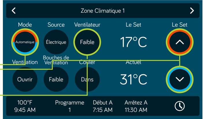
La fonction de programmation vous permet d'ajuster une température et de choisir le nombre de fois de mise en marche et d'arrêts, lorsque vous désirez que le contrôle de température opère.
